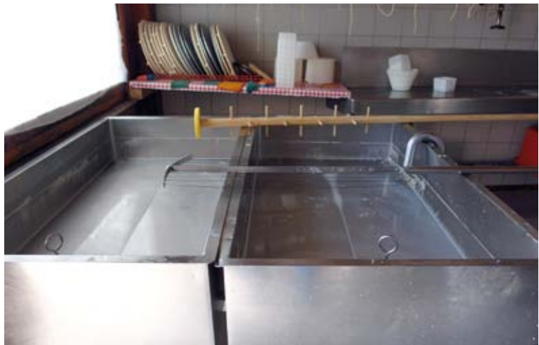
Aufrahmbehälter mit Kaltwasserumlauf
