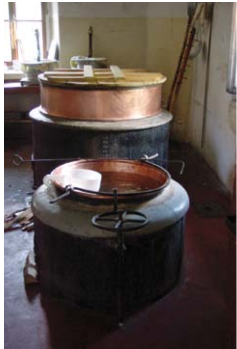
Caldaie tipo "Tremonti" durante la coagulazione
