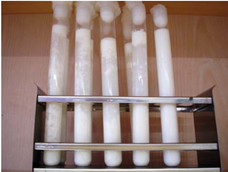
Gärproben mit Gärgläsern zur Erkennung von Coli Aerogenes
