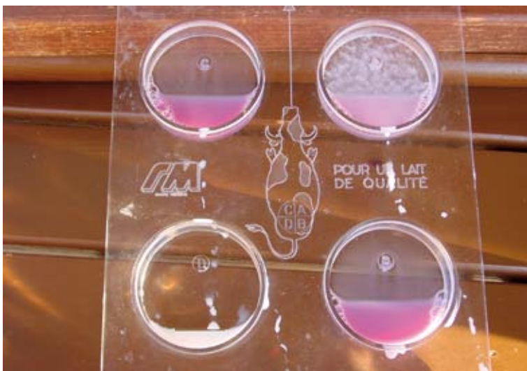
Prova del Leucocystest per rilevare la presenza di cellule somatiche (mastiti)
