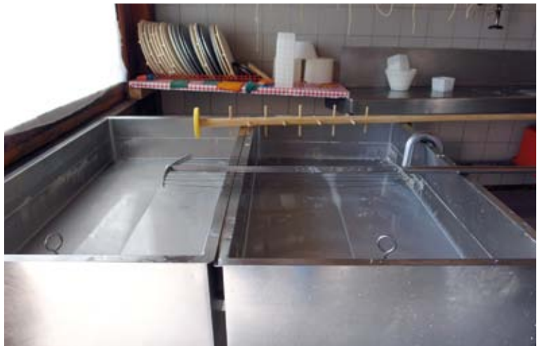
Vasche di affioramento con circolazione acqua fredda.
