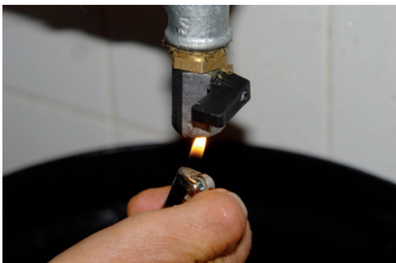
Figura 5: Preparazione del punto di prelievo per il campionamento microbiologico.
